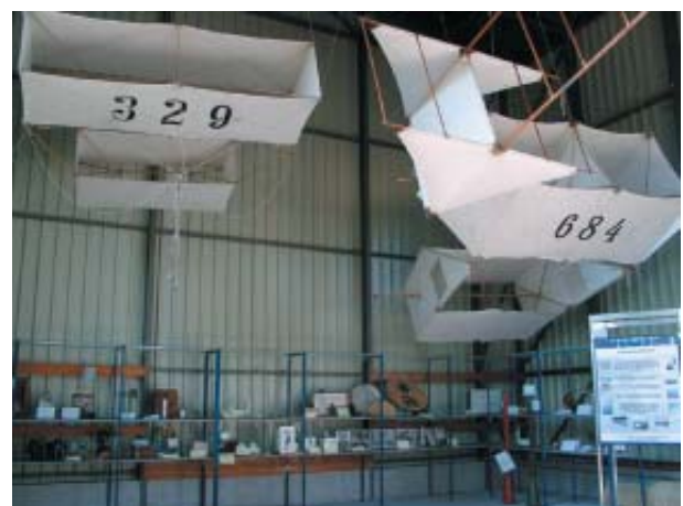
Historische meteorologische Drachen, Ballonhalle des Observatoriums, links: Hargrave-Schirm-Drachen 329 (7 m 2 ), rechts: Regulierdrachen nach Grund 684.
